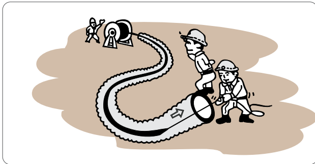
Luôn cáp dễ dàng, có thể bố trí hố ga cách xa nhau hơn Allows easy cable pull in and permits longer distances between handholes
